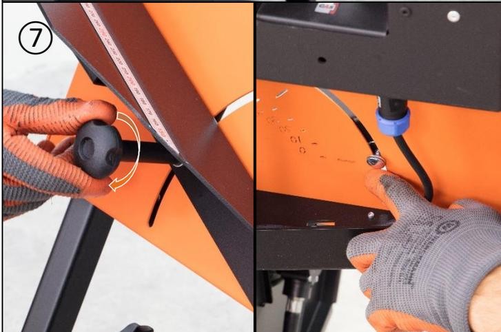
Sterngriff links mithilfe der Führungsschraube befestigen.
