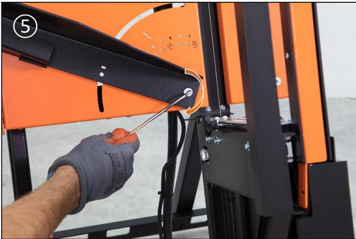
Den verstärkten Auflegewinkel links mithilfe der Flachkopfschraube befestigen.
