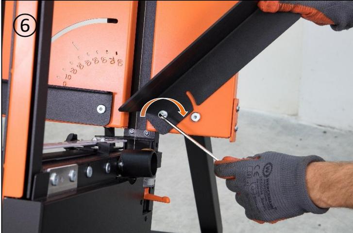
Den verstärkten Auflegewinkel rechts mithilfe der Flachkopfschraube befestigen.
