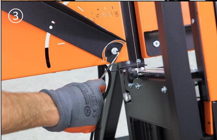
Flachkopfschraube am linken Auflegewinkel entfernen und Auflegewinkel abnehmen.
