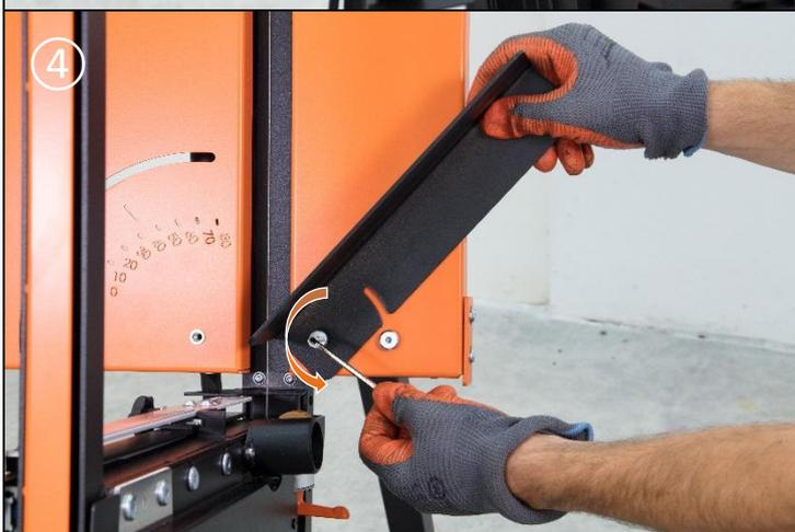
Flachkopfschraube am rechten Auflegewinkel entfernen und Auflegewinkel abnehmen.
